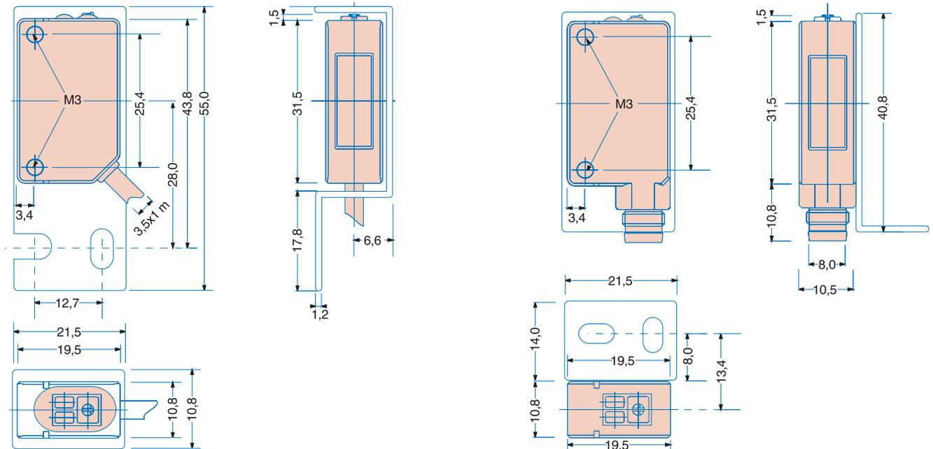
Abbildung im Maßstab 1:1. Alle Abmessungen in mm.
